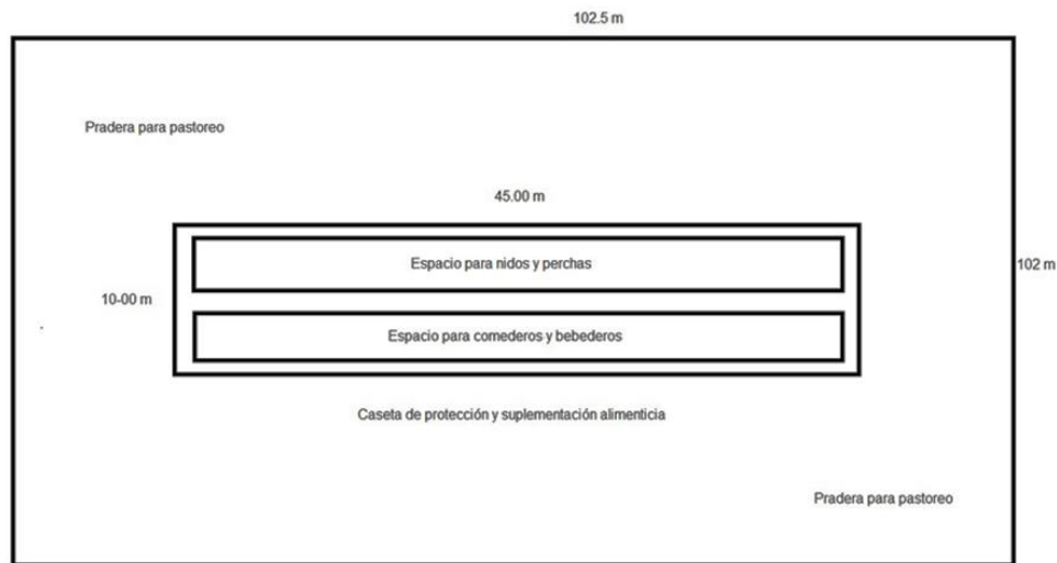
Figura 12. Propuesta para crianza semi-extensiva de guajolotes con praderas para pastoreo en un terreno de 10,455 m 2 . Diseñado para 75 machos adultos y 375 hembras adultas, con un promedio de 6 pavipollos criados al año (2,250 aves mixtas para venta al año). El sistema está diseñado para que se alimenten con pastoreo pero que se les suplemente durante la noche o la mañana con algún otro tipo de alimento concentrado.
