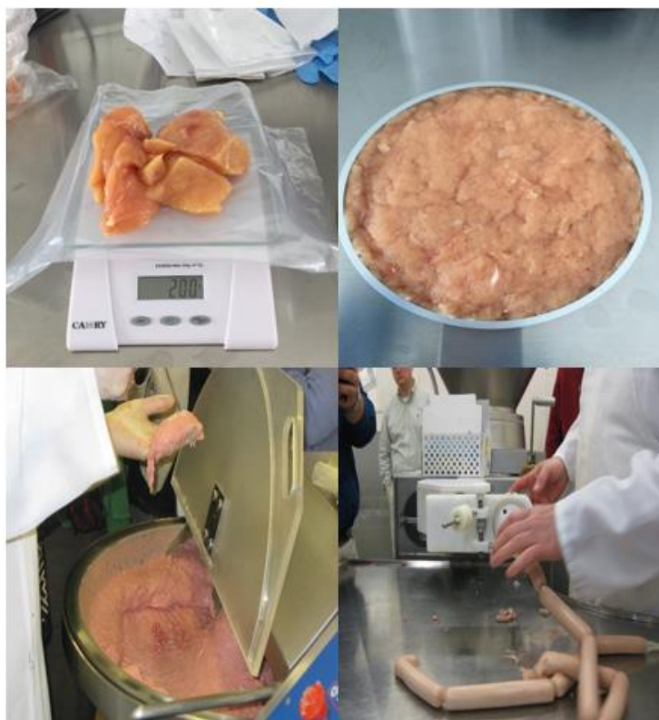
Figura 4. Preparación de carne de guajolote para elaboración de embutidos. En las fotos, elaborando salchicha.
